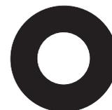
**R22/25** - vnitřní průměr 22 mm, vnější 25 mm
